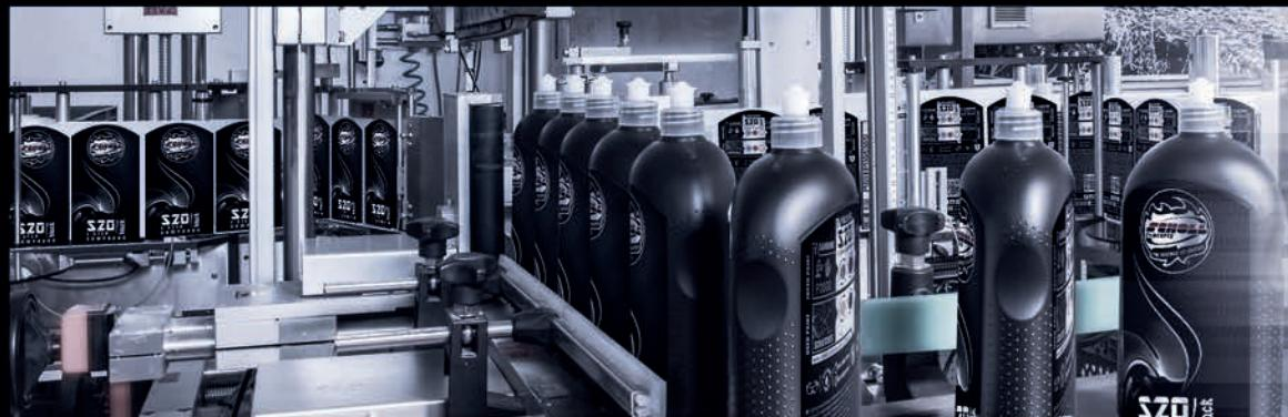
La innovación de nuestras fórmulas se refleja en nuestras instalaciones de producción química. Un concepto de fabricación modular atípico y un sistema de control gravimétrico totalmente automatizado garantizan una producción rentable y eficiente. Una nueva línea de llenado de alta capacidad gestiona el complejo proceso de llenado de nuestros productos en botellas y envases pequeños y grandes.
